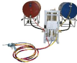
Injetora pneumática de poliuretano equipada com bombas de pistão
