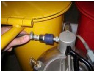
Para fazer a conexão da linha de ar ou compressor com a máquina, encaixe o mangote de interconexão da linha de ar usando um adaptador de 1/2 polegada gás para 1/4 gás se for necessário. Encaixe a outra extremidade na máquina através do engate rápido.
